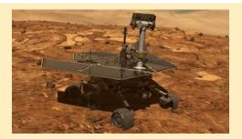
Ce robot se déplace et fait des prélèvements à la surface de Mars depuis le début de l'année 2004. Pour pouvoir fonctionner, il se **recharge** ses batteries grâce à ces capteurs solaires .
