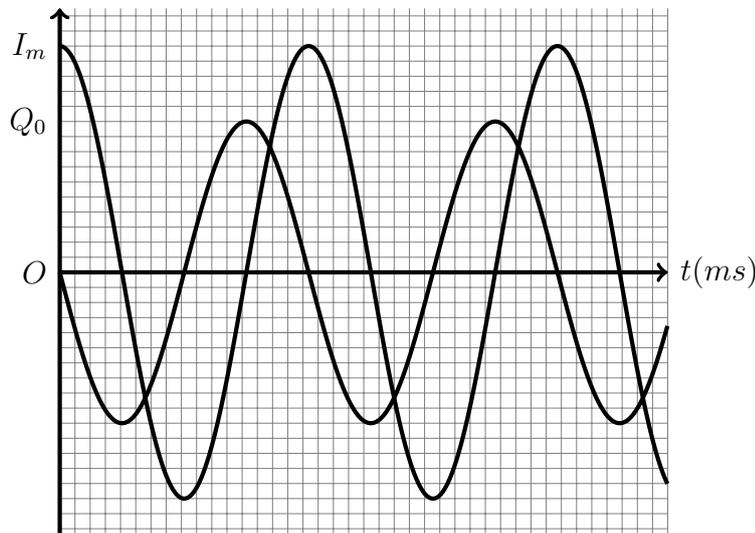
ملحوظة : عندما تكون شحنة المكثف قصوى تكون شدة التيار الكهربائي منعدمة . والعكس صحيح
