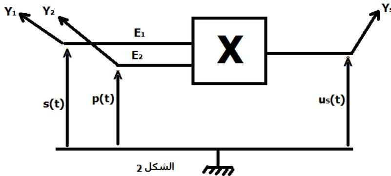
بالنسبة للتوتر  $s(t)$  : وسعها  $S_m = 1V$  وترددتها  $f_s = 100Hz$  و التوتر المستمر :  $U_0 = 1,5V > S_m$  نعاينه على شاشة راسم التذبذب في المدخل  $Y_1$  الشكل 3
