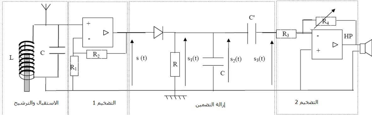
الاستقبال والترشيح  $C=1\text{nF}, L=0,1\text{mH} \text{ à } 0,3\text{ mH}$
