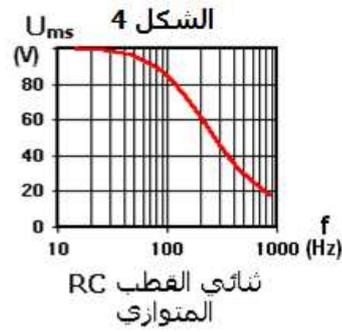
نسمي مرشح ممرر الإشارات ذات ترددات المنخفضة (filtre passe-bas) الدارة الكهربائية التي تسمح بمرور إشارات ذات ترددات منخفضة . نسمي مرشح ممرر الإشارات ذات ترددات العالية (filtre passe-haut) الدارة الكهربائية التي تسمح بمرور إشارات ذات ترددات عالية .
