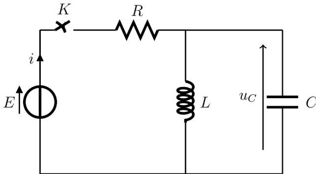
نعتبر التركيب الممثل في الشكل جانبه حيث  $E = 12V$  و  $C = 0,45\mu F$  و  $R = 25\Omega$  ومعامل التحريض  $L$  للوشية ذات المقاومة المهملة مجهول . نعتبر أن قاطع التيار الكهربائي  $K$  مغلق مدة كافية للحصول على النظام الدائم .
